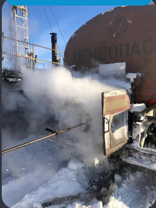
Отогрев задвижек Специализированной техники
